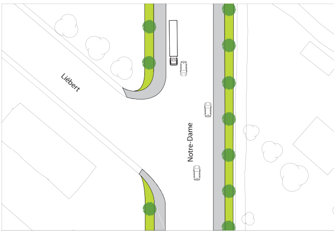
Bande verte longeant les édifices. Le trottoir reste adjacent à la rue.
